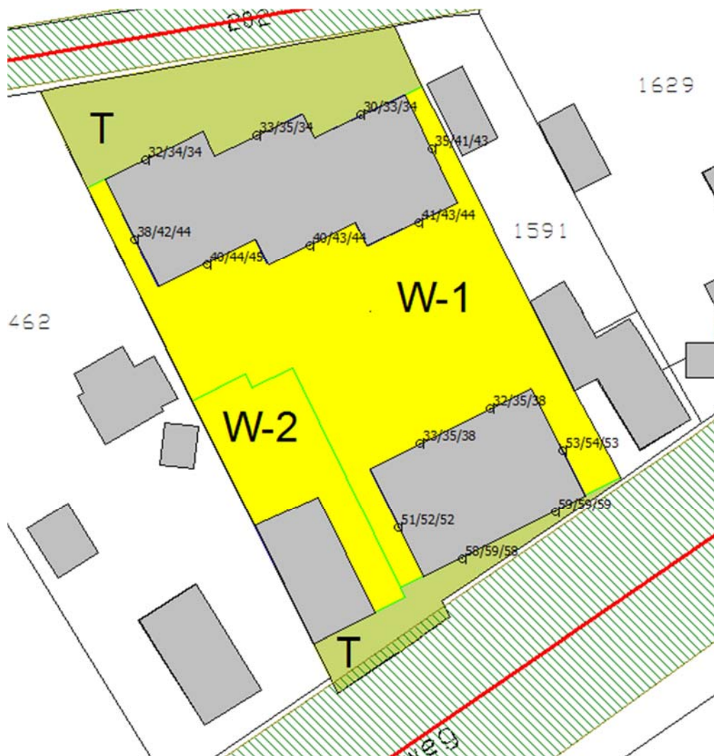
Figuur 4.1 Geluidsbelasting ten gevolge van het verkeer op de Zuiderzeestraatweg per waarneempunt op 1,5 m, 4,5 m en 7,5 m hoogte
