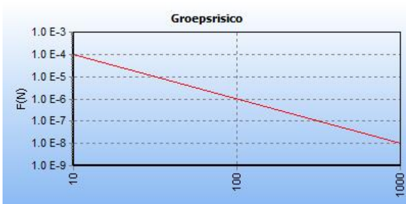
5.2 Figuur 5.2 FN curve voor 9128_leiding-N-576-67-deel-2 van N.V. Nederlandse Gasunie voor de kilometer tussen stationing 0.00 en stationing 470.00
