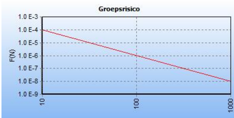
5.4 Figuur 5.4 FN curve voor 9128_leiding-N-576-69-deel-1 van N.V. Nederlandse Gasunie voor de kilometer tussen stationing 0.00 en stationing 120.00
