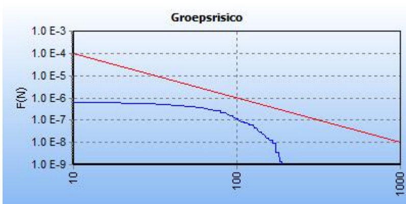
5.2 Figuur 5.2 FN curve voor 9128_leiding-N-576-67-deel-2 van N.V. Nederlandse Gasunie voor de kilometer tussen stationing 0.00 en stationing 470.00
