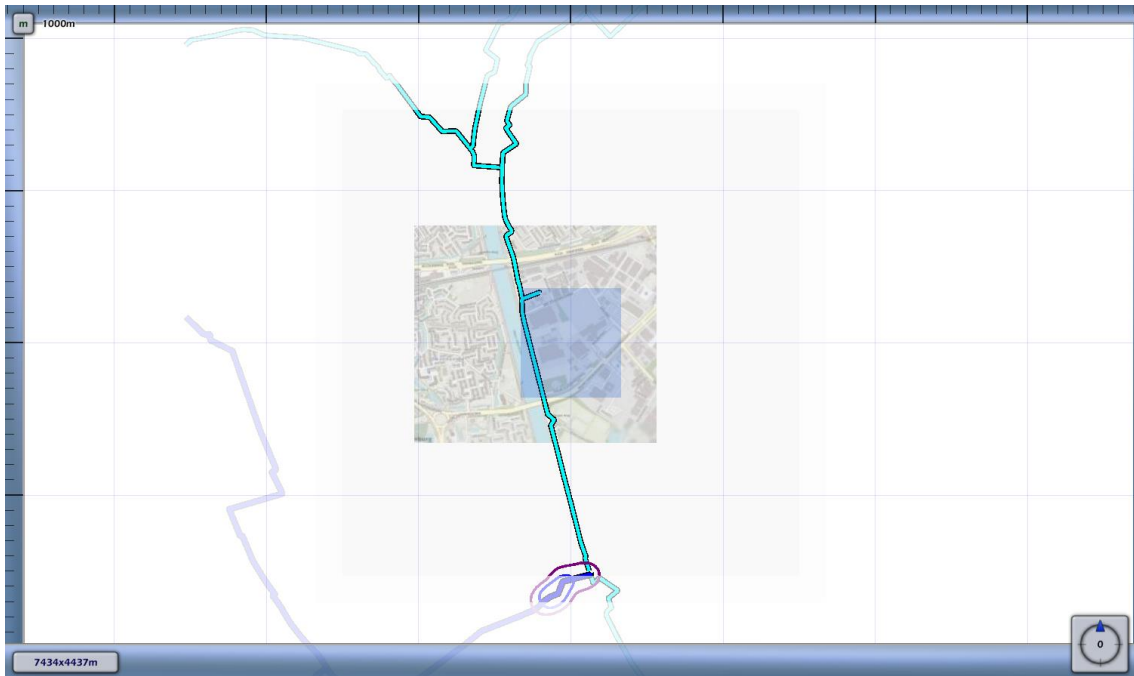
3.6 Figuur 3.6 Plaatsgebonden risico voor 9128_leiding-N-576-73-deel-1 van N.V. Nederlandse Gasunie
