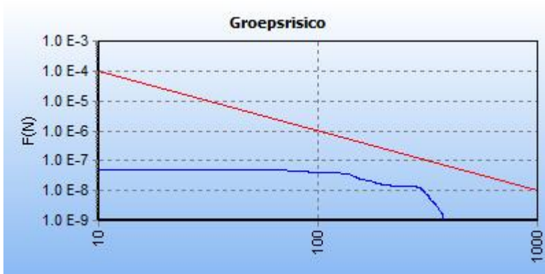
5.5 Figuur 5.5 FN curve voor 9128_leiding-N-576-70-deel-1 van N.V. Nederlandse Gasunie voor de kilometer tussen stationing 5300.00 en stationing 5350.00
