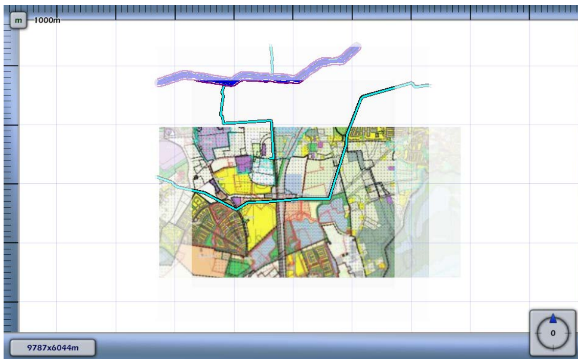
3.8 Figuur 3.8 Plaatsgebonden risico voor 4744_leiding-N-578-20-deel-1 van N.V. Nederlandse Gasunie
