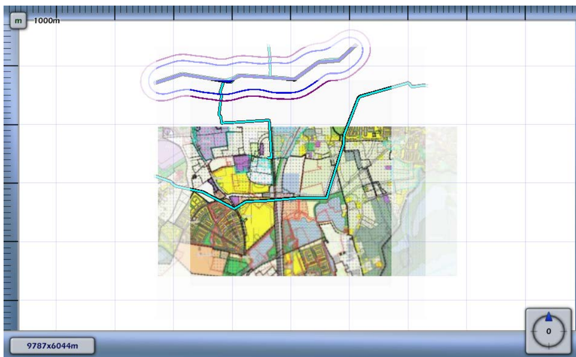
3.1 Figuur 3.1 Plaatsgebonden risico voor 4744_leiding-A-505-deel-1 van N.V. Nederlandse Gasunie
