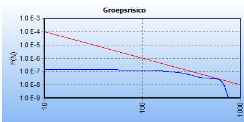
5.5 Figuur 5.5 FN curve voor 4744_leiding-A-663-deel-1 van N.V. Nederlandse Gasunie voor de kilometer tussen stationing 0.00 en stationing 0.00
