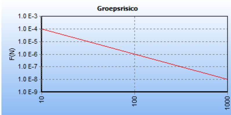
5.2 Figuur 5.2 FN curve voor 4744_leiding-A-507-deel-1 van N.V. Nederlandse Gasunie voor de kilometer tussen stationing 2370.00 en stationing 2460.00
