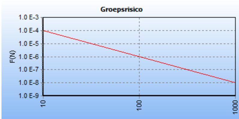
5.2 Figuur 5.2 FN curve voor 4744_leiding-A-507-deel-1 van N.V. Nederlandse Gasunie voor de kilometer tussen stationing 2370.00 en stationing 2460.00
