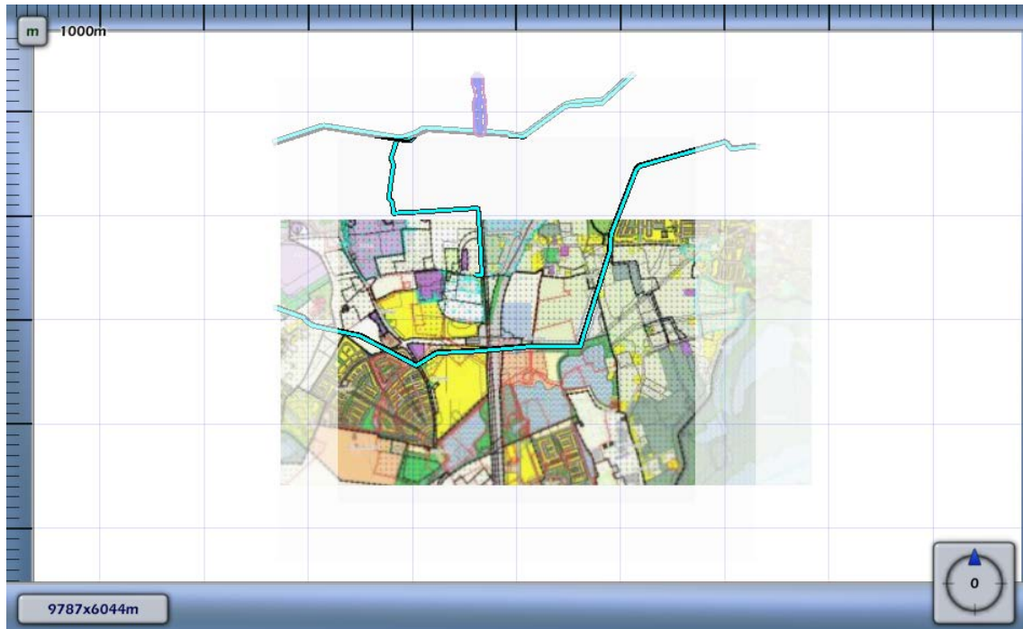
3.7 Figuur 3.7 Plaatsgebonden risico voor 4744_leiding-N-578-19-deel-1 van N.V. Nederlandse Gasunie
