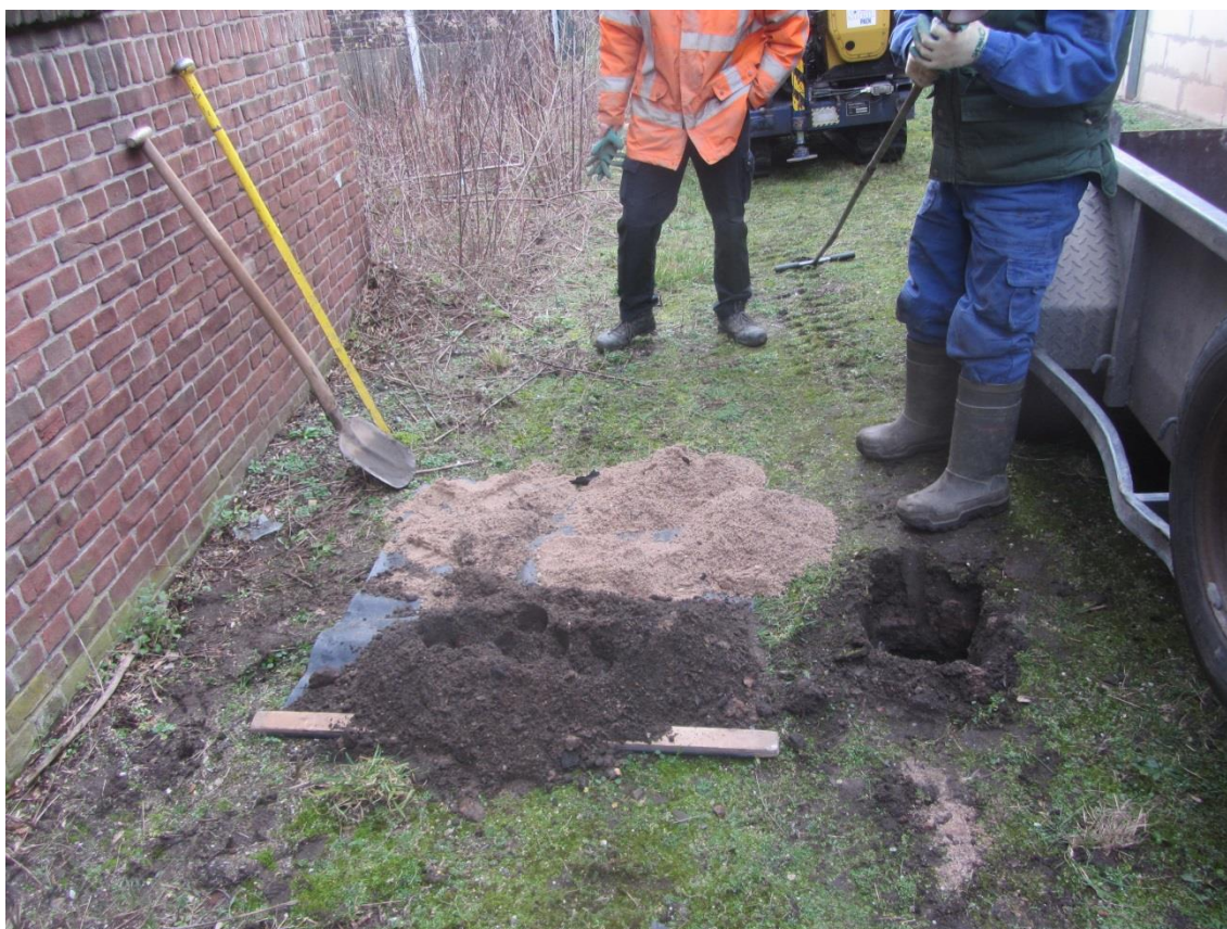
Figuur 13: Opgeboord sediment. Het gele zandpakket is meer dan 3 meter dik
