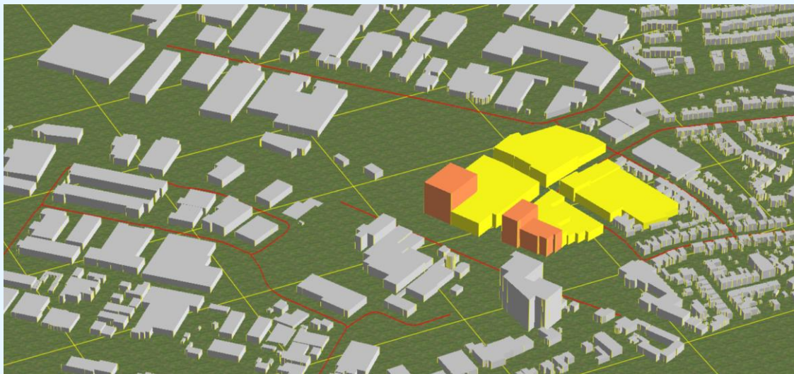
figuur 4: 3D-overzicht van het akoestisch rekenmodel met het plan in het oranje en geel weergegeven
