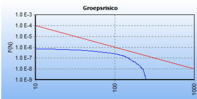
5.1 Figuur 5.1 FN curve voor 6626_leiding-A-510-deel-1 van N.V. Nederlandse Gasunie voor de kilometer tussen stationing 2090.00 en stationing 3090.00
