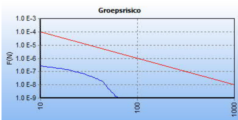
Afbeelding 6 fN-curve buisleiding A-510-deel-1, huidige situatie
