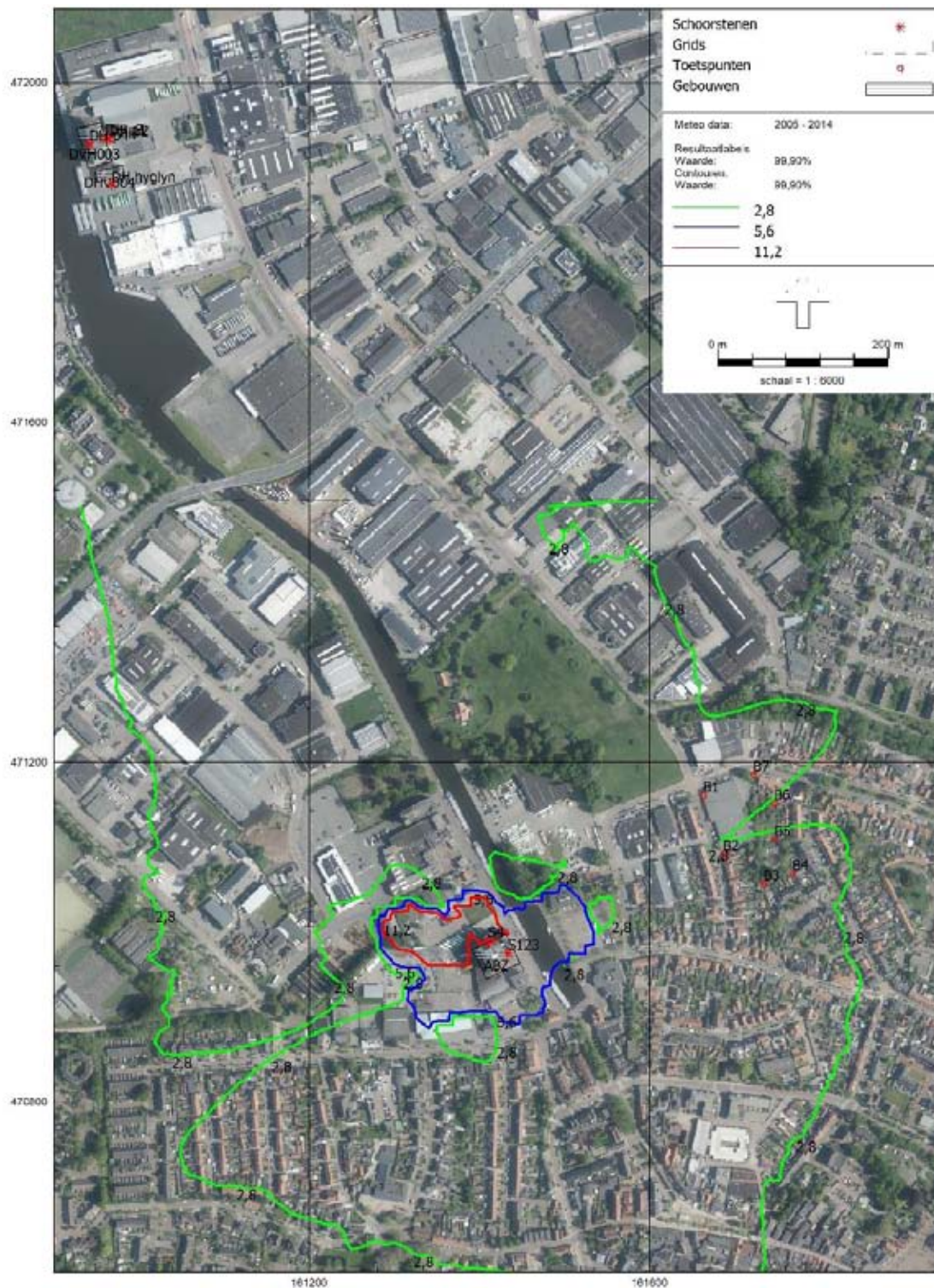
Figuur f Geurcontouren van 2,8; 5,6 en 11,2 ou E /m 3 als 99,9-percentielwaarde als gevolg van ABZ en De Heus te Nijkerk
