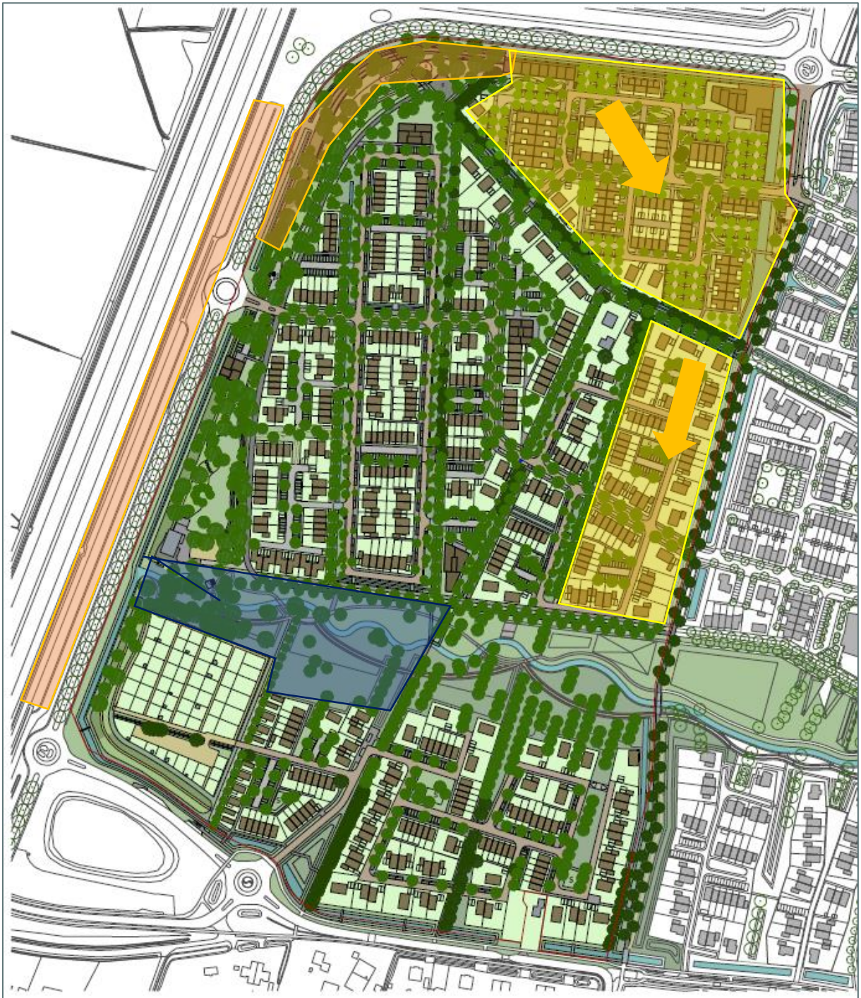
Figuur 2.5. Geplande fasering van Doornsteeg fase 3. In oranje is de geluidswal weergegeven, in blauw deel 1 van het beekpark en in geel deel 1 van de woningbouw. De ontwikkeling van de woningen start in het noorden en volgt de pijlen.
