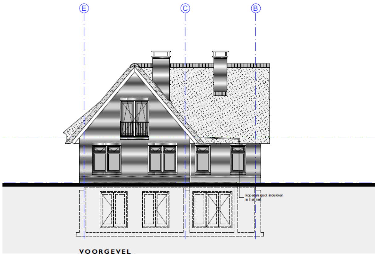
Afbeelding 3: indruk van voorgevel nieuw te bouwen woning
