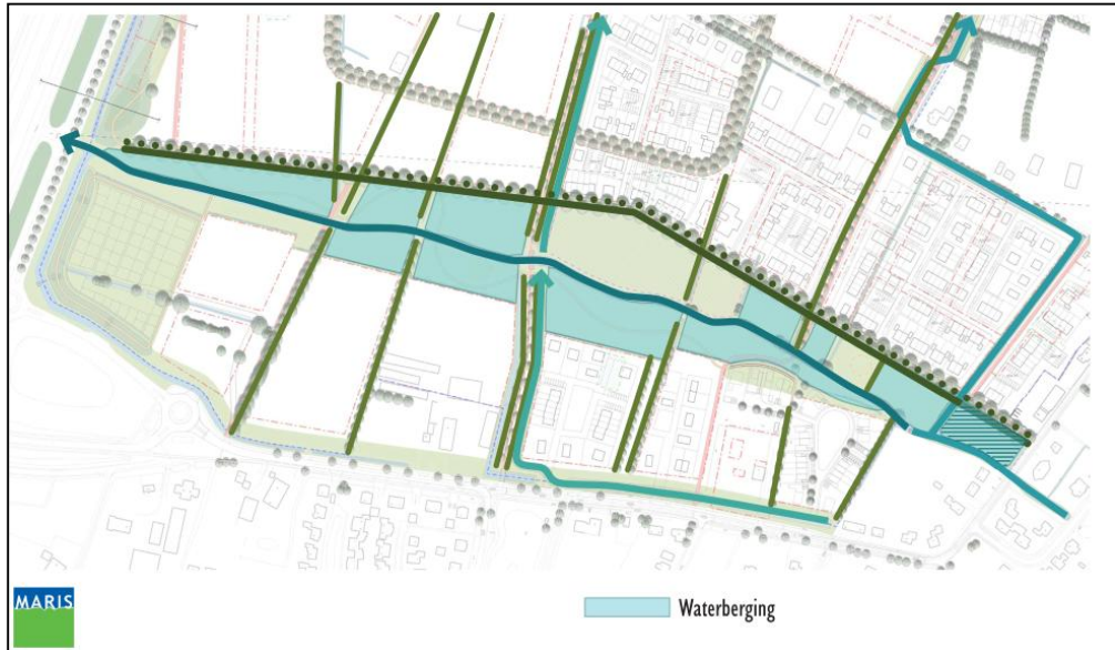
Figuur 16: Schets van de benodigde waterberging (circa 33.400 m 2 ) in de beekdalzone (bron: Maris)
