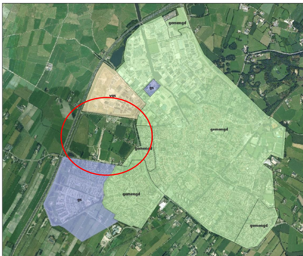
Figuur 5: Rioolstelsel in Nijkerk. In de groene gebieden bevindt zich een gemengd rioolstelsel, in de paarse gebieden een gescheiden rioolstelsel en in het oranje gebied een verbeterd gescheiden rioolstelsel. Het gebied Doornsteeg is met een rode cirkel weergegeven.
