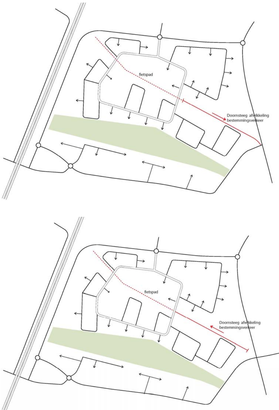
Figuur 2: Ontsluitingsalternatieven bestaande kavels Doornsteeg bovenste figuur via Holkerweg en onderste figuur via de 'Allee'
