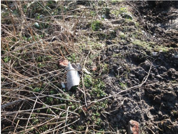
Foto asbestverdacht materiaal op maaiveld
