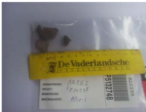
Afbeelding 2: waargenomen stukjes asbestverdacht plaatmateriaal ter plaatse van ABG9
