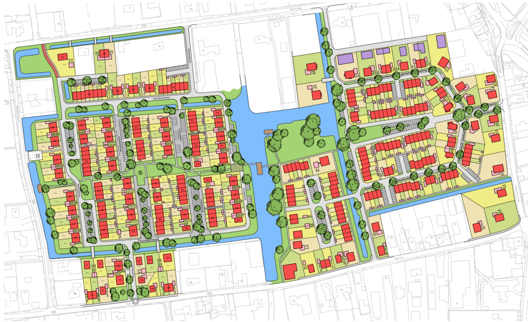
Figuur 1 Bin de nieuw situatie zijn bestaande watergangen verbreed, de oevers opnieuw geprofileerd en zijn er kunstwerken geplaatst in en langs het water (bron: Compositie 5, Stedenbouw b.v.).
