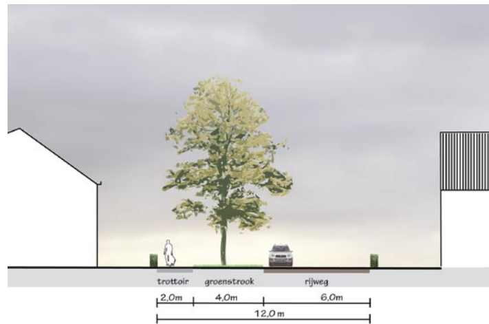
B. Principeprofiel hoofdontsluiting vanaf het Hoorzijk (Kersenstraat)
