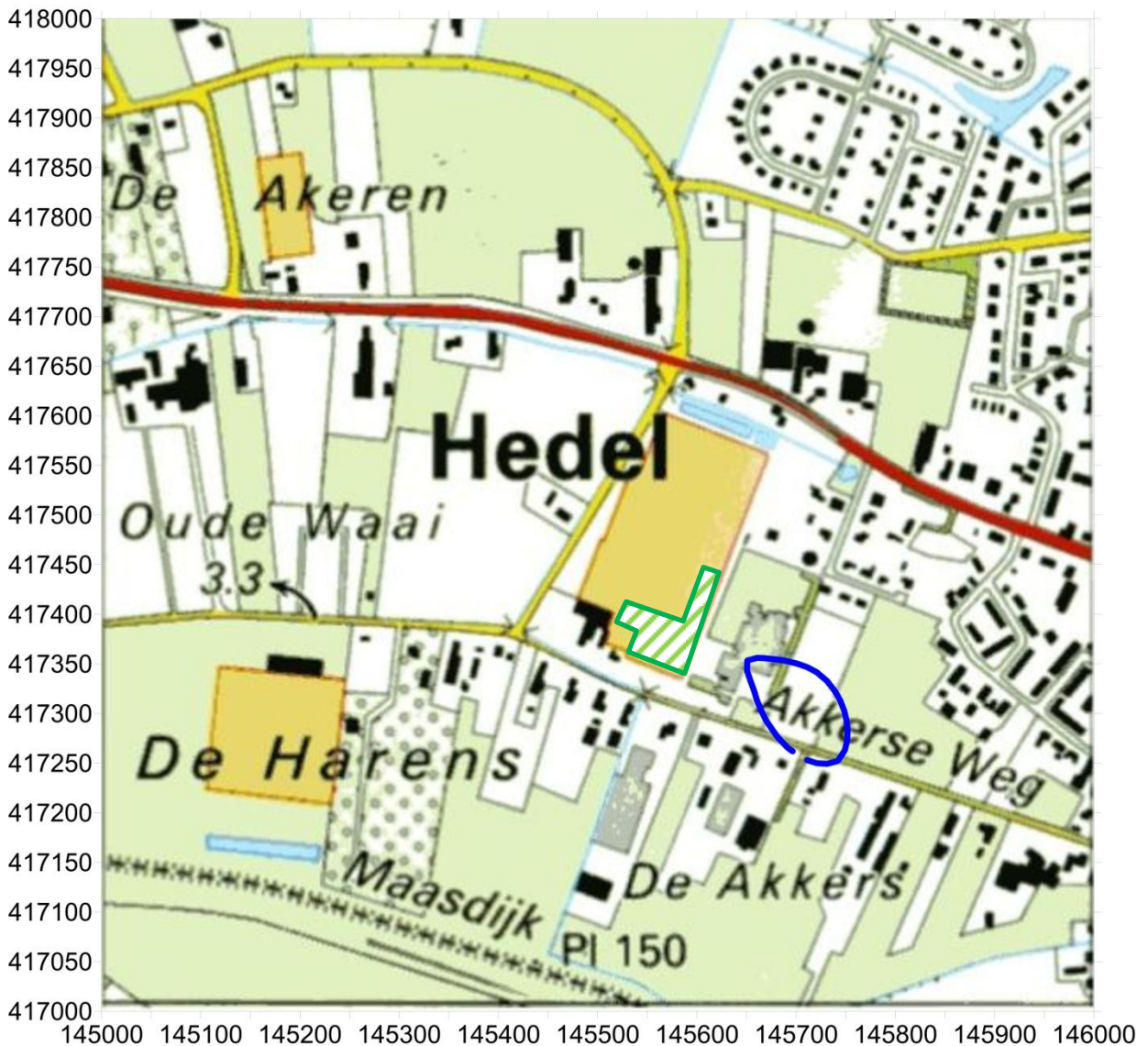
Figuur c: Geurcontour van 2,5 \text{ge}/\text{m}^3 ofwel 1,25 \text{ou}_E/\text{m}^3 als 98-percentielwaarde als gevolg van aardappelverwerkende activiteiten van Quik Holding BV in de vergunde situatie (met rendement 98%). De locatie van de bestemming 'wonen' binnen het plangebied Hedel herziening 2014 is groen gearceerd weergegeven.
