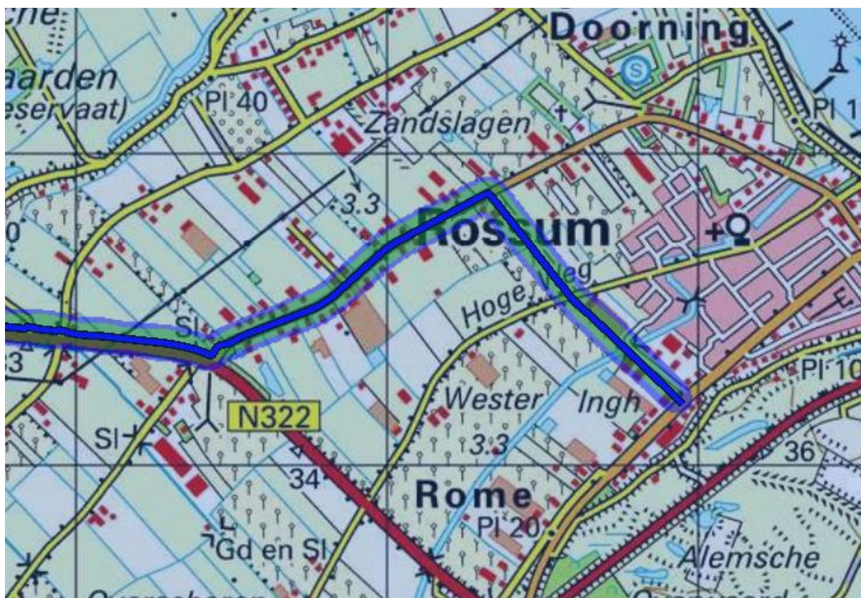
Figuur 4 Ligging van gastransportleiding W-531-03 (donkerblauw). De contouren van het PR van 10^{-7} en 10^{-8} per jaar van de leiding worden respectievelijk weergegeven met groene en blauwe gebieden. Het niveau van 10^{-6} per jaar wordt niet bereikt.
