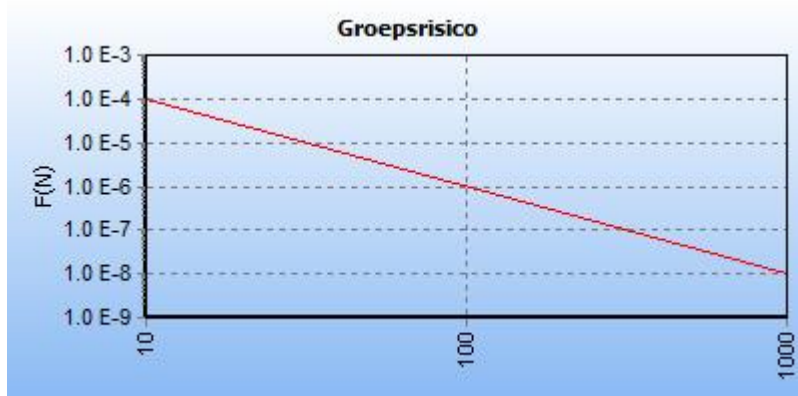
5.3 Figuur 5.3 FN curve voor 3764_leiding-N-560-08-deel-1 van N.V. Nederlandse Gasunie voor de kilometer tussen stationing 0.00 en stationing 70.00
