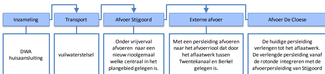
Figuur 9: schematische weergave van het vuilwater afvoerprincipe
