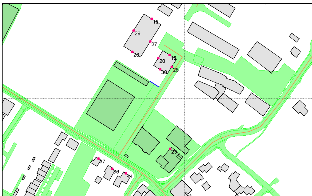
Figuur 5 Hoogst berekende geluidbelasting vanwege de Hoogstraat
