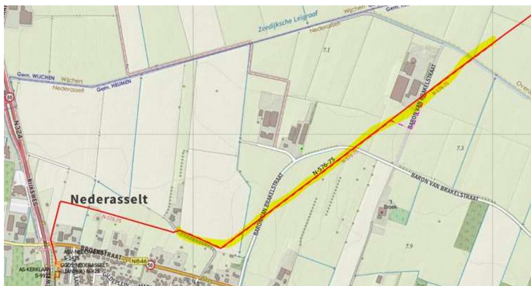
Figuur 1. Ligging van de ingreeplocatie leiding N-576-75 in het buitengebied ten noorden van Nederasselt, gemeente Heumen. Het geelgearceerde deel van de leiding wordt dieper gelegd (lengte circa 1350 meter). Bij Baron van Brakelstraat 5 wordt de nieuwe leiding om het erf gelegd (paarse stippellijn).
