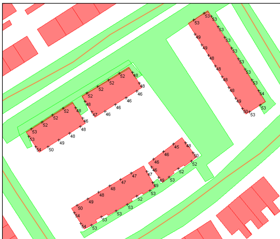
Figuur 2 Hoogst berekende gecumuleerde geluidbelasting exclusief aftrek
