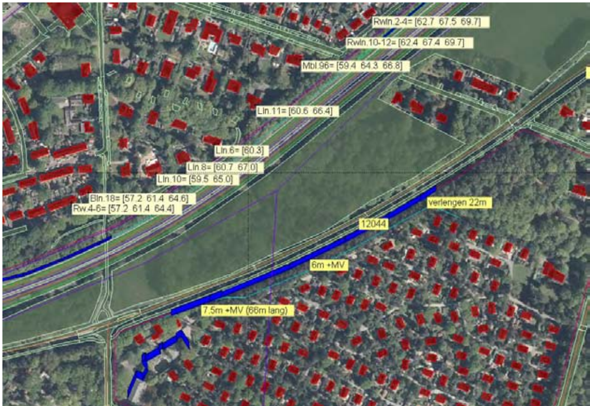
Geluidbelasting L_{den} in dB vanwege de A88 – zonder aftrek– conform GPP Schermen 6.0-7.5m hoog, begroeiing na 2-3 jaar (refl. 50%, Hw=1.5, 4.5, 7.5m)
