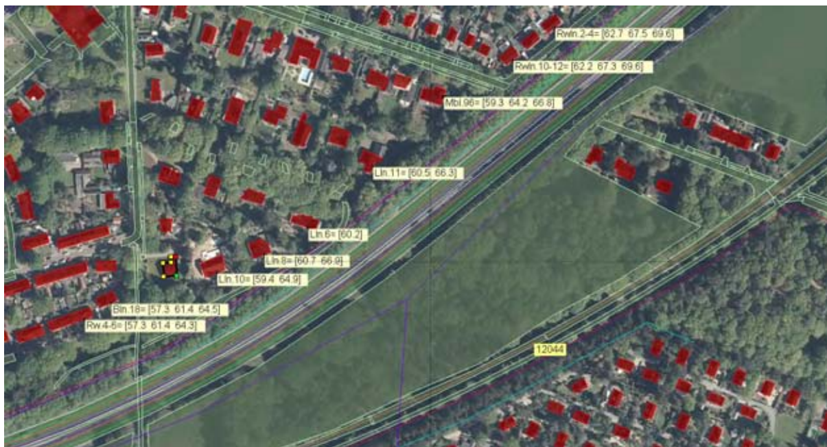
Geluidbelasting L_{den} in dB vanwege de A28 – zonder aftrek – conform GPP Zonder scherm ( H_w=1.5, 4.5, 7.5m )
