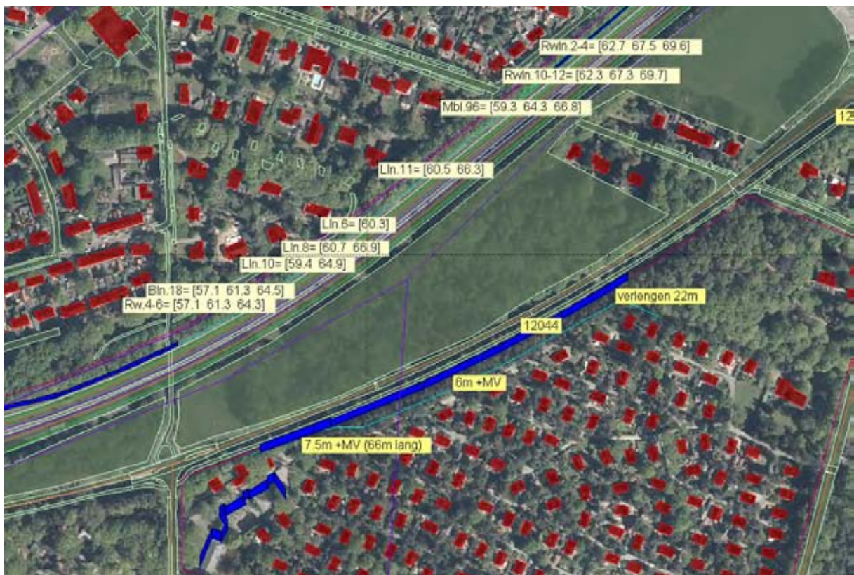
Geluidbelasting L_{den} in dB vanwege de A88 – zonder aftrek– conform GPP Schermen 6.0-7.5m hoog begroeiing na 4-5 jaar (refl. 30, Hw=1.5, 4.5, 7.5m)
