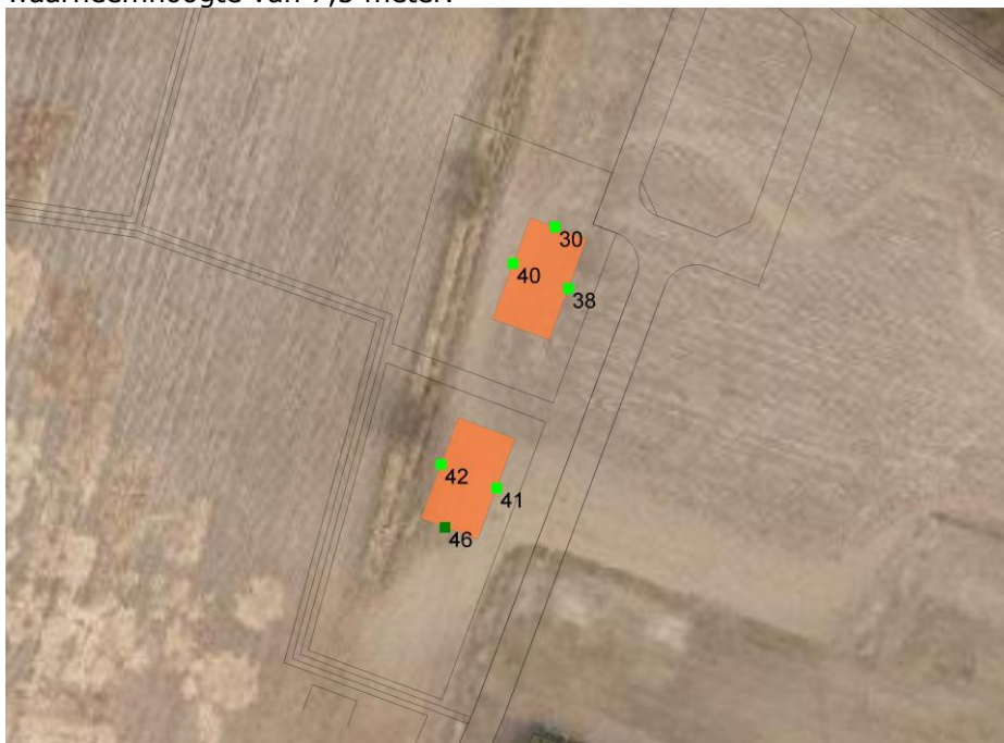
Figuur 7 Geluidbelasting tgv Fokko kortlanglaan incl. aftrek art. 110g op een waarneemhoogte van 7,5 m.
