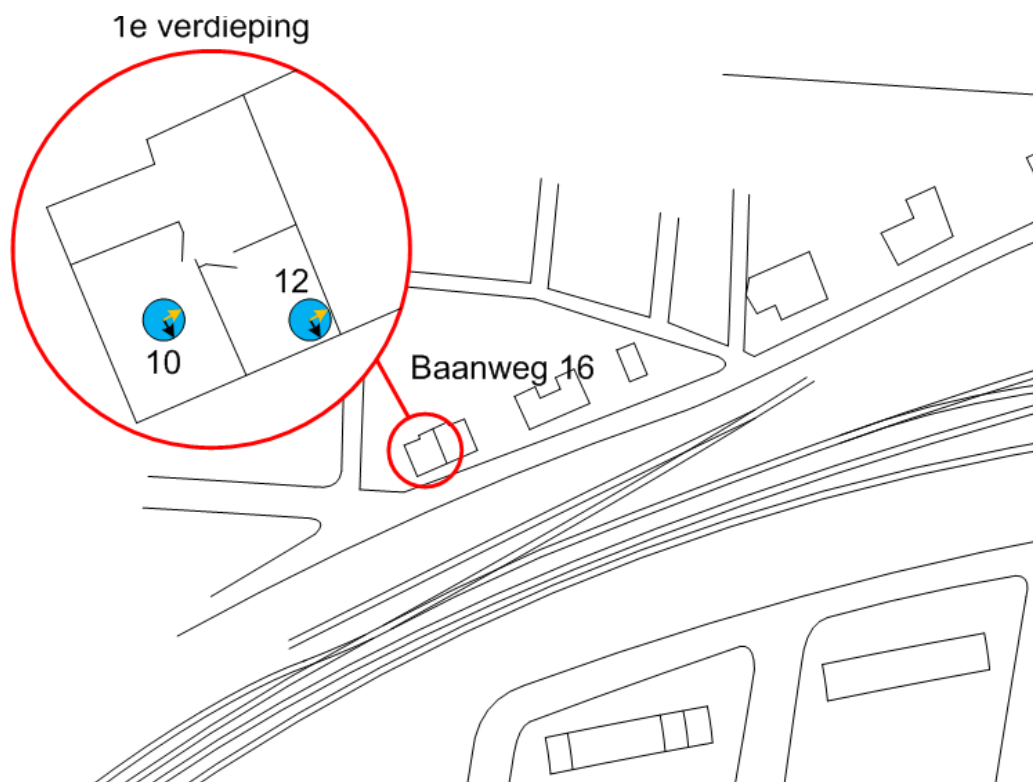
Figuur 5-5 Opstelling sensoren Baanweg 16
