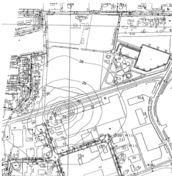
Concentraties fijn stof (in \mu\text{g}/\text{m}^3 ) ten gevolge van de motverbrandingsinstallatie Kegro
