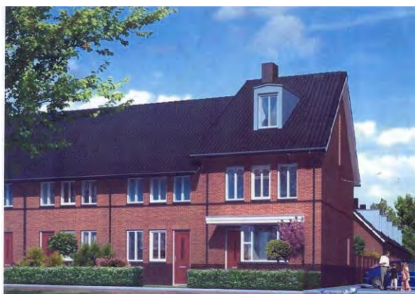
Verbijzondering van de hoekwoning; hogere gesitueerde goot, hogere ramen op de verdieping, erker en luifel op de begane grond.
