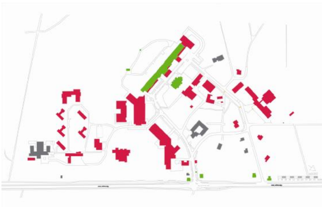
Te behouden bebouwing in groen (gemeentelijk monument) en grijs, te amoveren in rood
