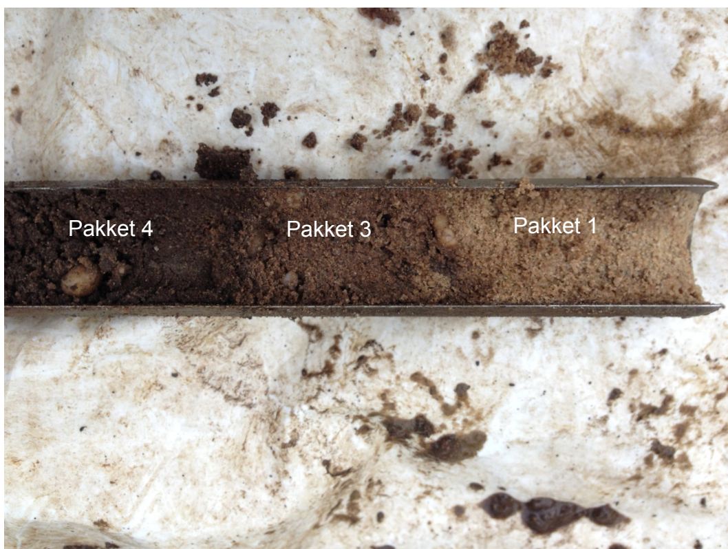
Figuur 8 De overgang van het plaggendek naar de C-horizont in boorprofiel 6.
