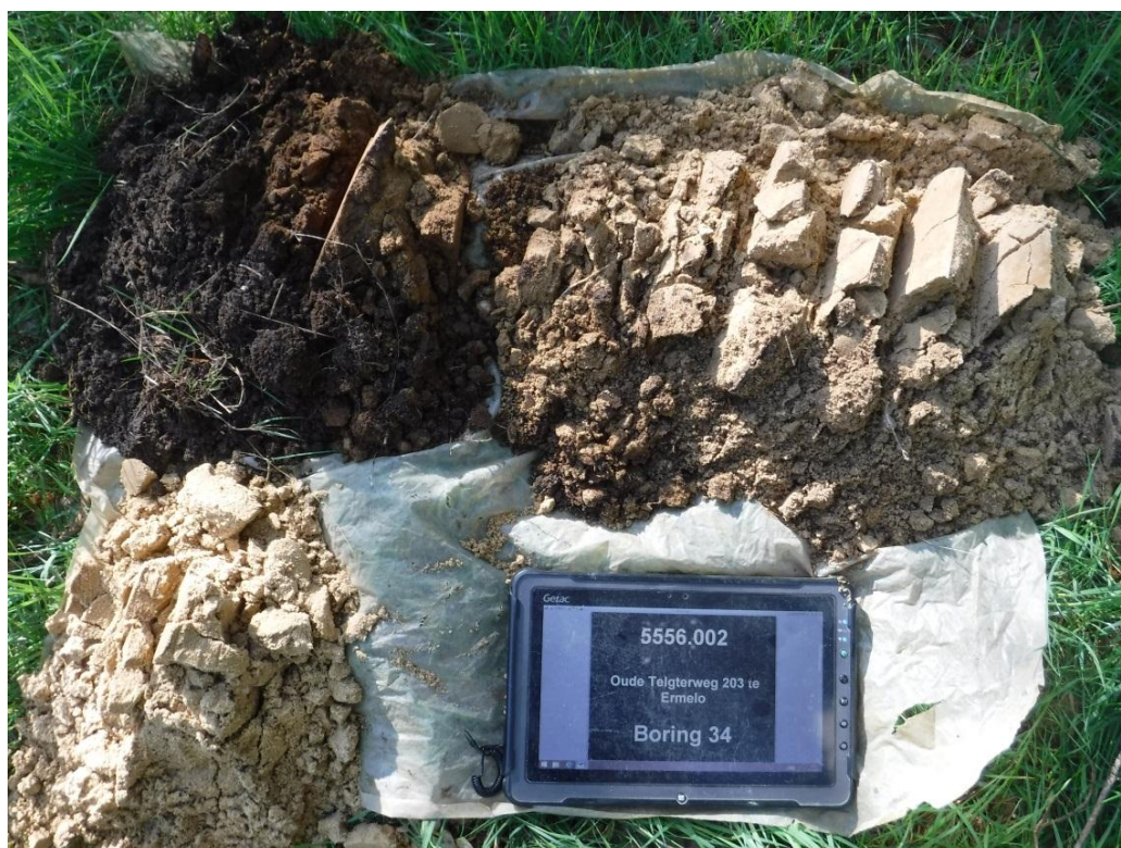
Figuur 3. Boring 34: intact bodemprofiel
