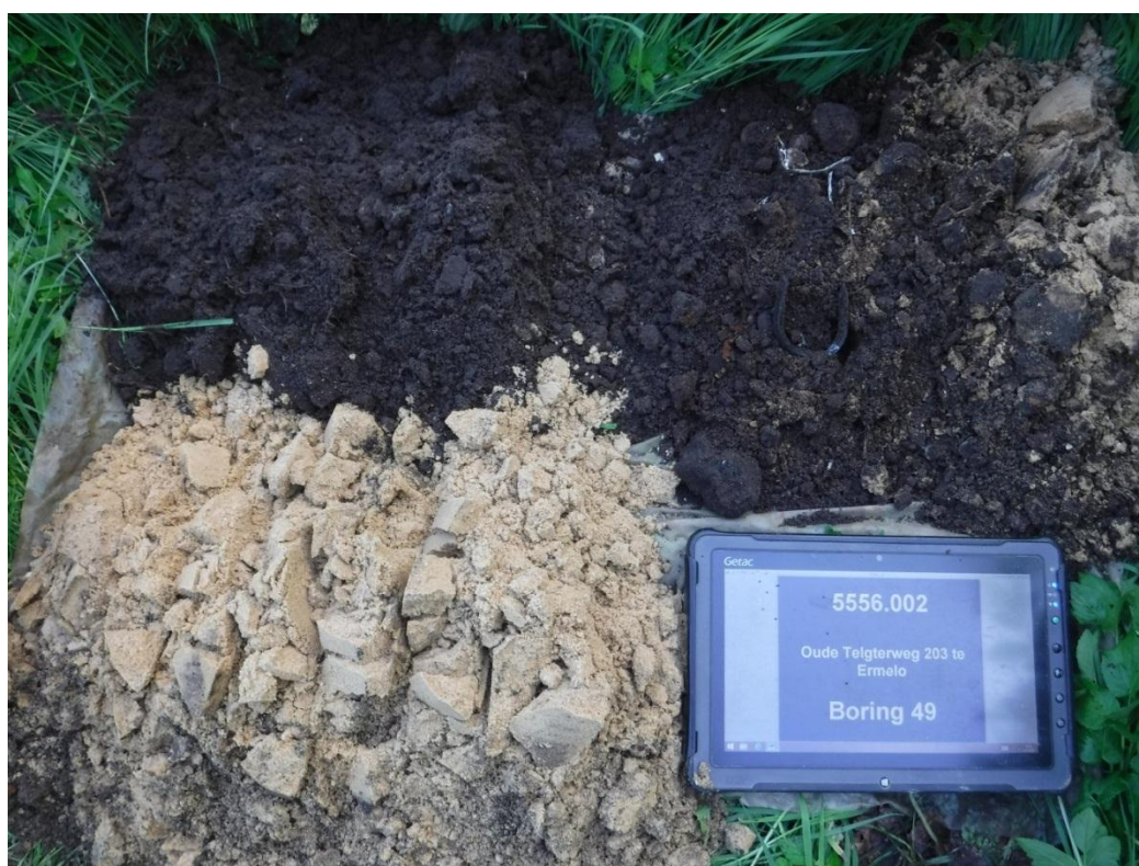
Figuur 4. Boring 49: Een verstoord bodemprofiel met resten van de vuilstort.
