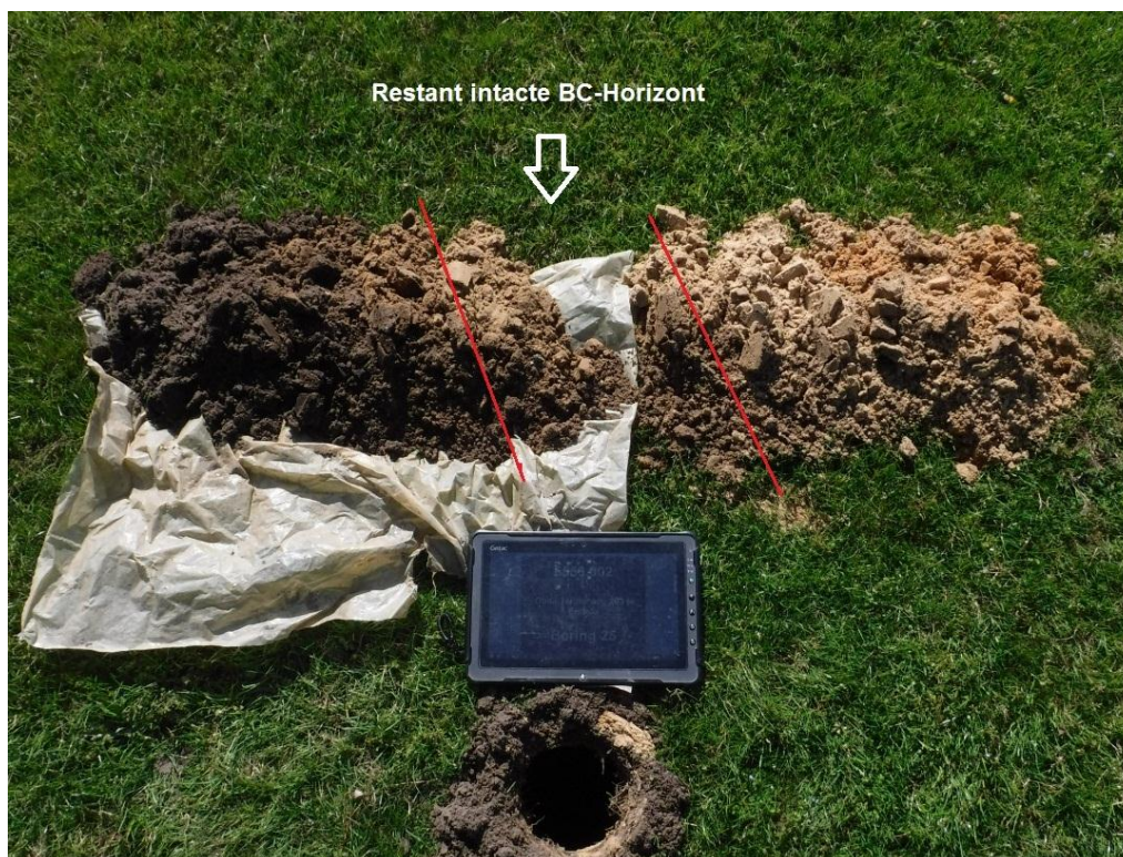
Figuur 2: Boring 25: bodemprofiel met restant van intacte BC-horizont
