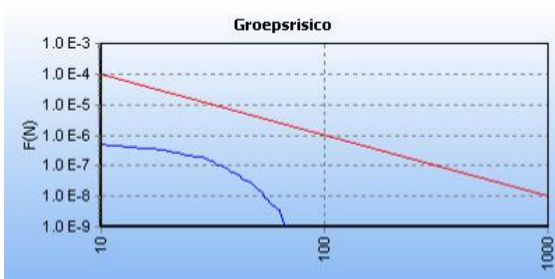
5.5 Figuur 5.5 FN curve voor 1969_leiding-N-570-26-deel-1 van N.V. Nederlandse Gasunie voor de kilometer tussen stationing 0.00 en stationing 0.00
