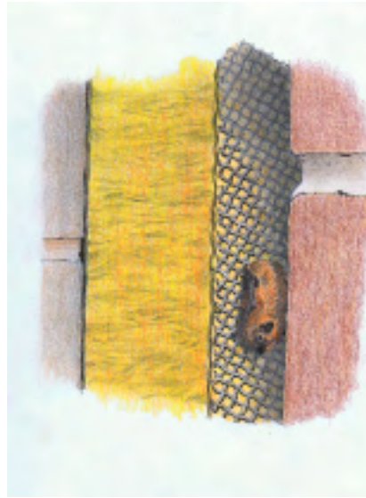
Figuur 7. Vleermuis hangt aan griplaag op isolatiemateriaal
