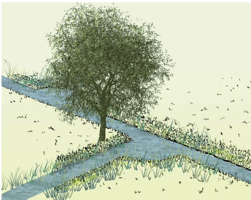
Plaatselijk verbrede sloten met natuurvriendelijke oevers
