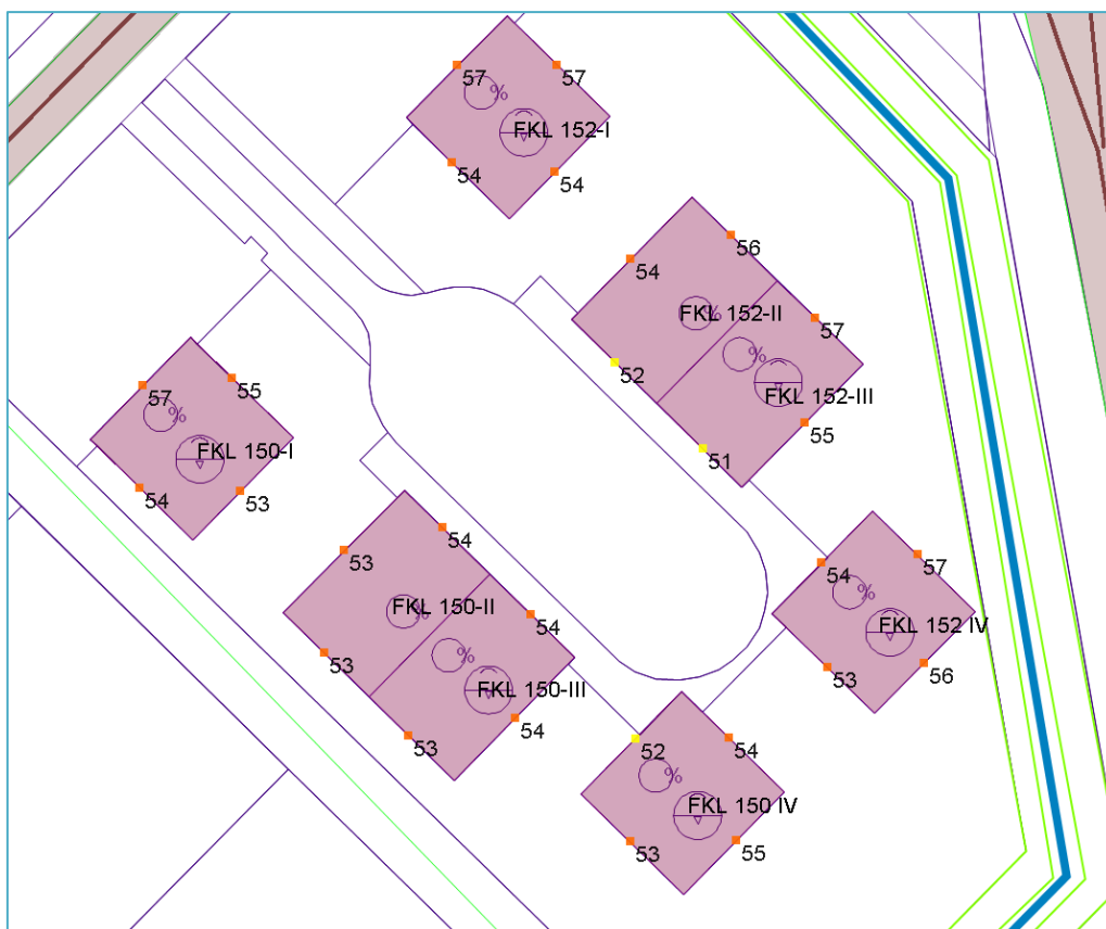
Gecumuleerde geluidsbelasting met kleur GES-score door spoor en wegen (spoor omgerekend naar wegverkeerslawaai)
