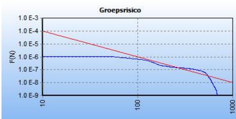
5.1 Figuur 5.1 FN curve voor 4844_leiding-A-510-deel-1 van N.V. Nederlandse Gasunie voor de kilometer tussen stationing 1860.00 en stationing 2860.00
