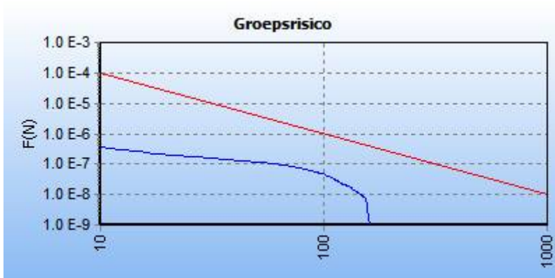
5.2 Figuur 5.2 FN curve voor 4844_leiding-N-570-20-deel-1 van N.V. Nederlandse Gasunie voor de kilometer tussen stationing 1790.00 en stationing 2790.00
