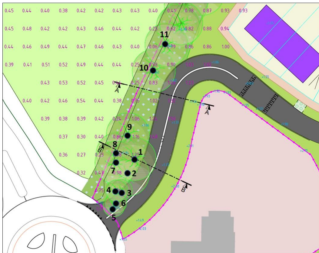
Figuur 2 Bomen (1-11) met werkzaamheden binnen de kwetsbare boomzone
