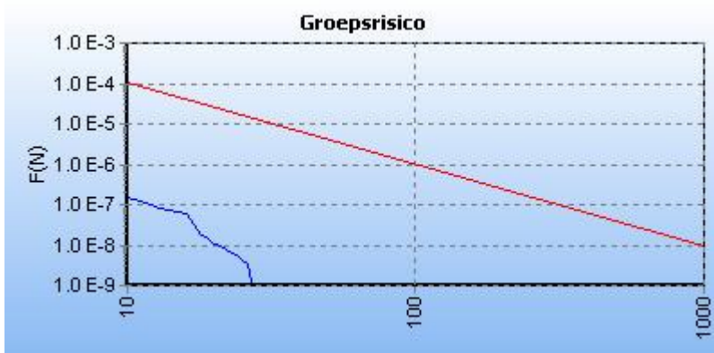
Figuur 5.1 FN curve voor A-570-01 van N.V. Nederlandse Gasunie voor de kilometer tussen stationing 3630.00 en stationing 4630.00
