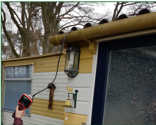
Afb. 2.14: Met behulp van een endoscoop is de geschiktheid en aanwezigheid van gebruikssporen van de chaletdaken onderzocht.
