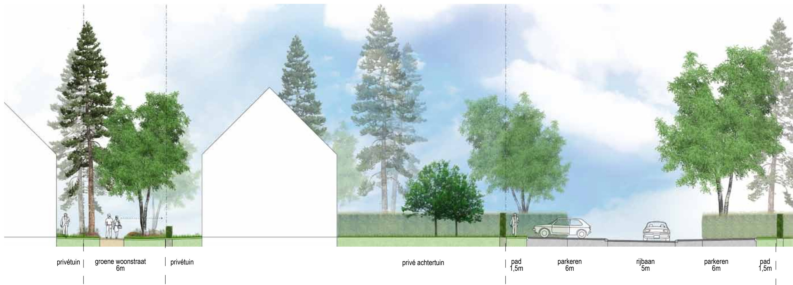
Doorsnede over één van de groene woonpaden en één van de oost westelijke inprikkers die toegang geven tot het parkeercluster in het Heidewoonlandschap
