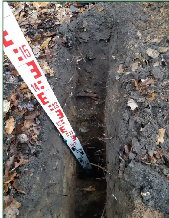
Figuur 9. In de sleuf zijn fijne en dunne wortels aangetroffen
