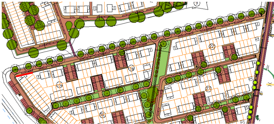
Figuur 13: Scherm wat noodzakelijk is vanwege de A30 in rood (1,80m hoogte)
