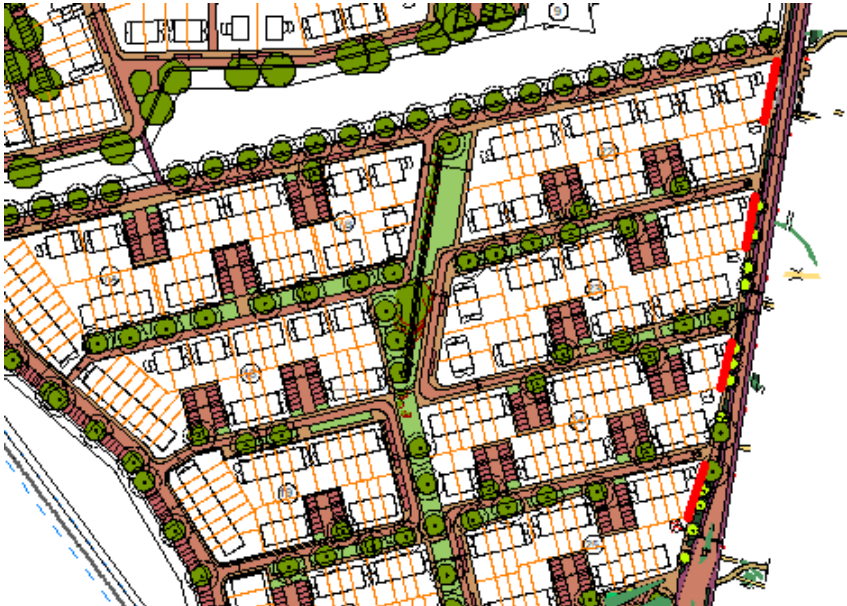
Figuur 16: Scherm wat noodzakelijk is vanwege de Veenwoud 30km/uur in rood (1,80m hoogte)
