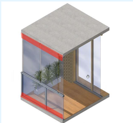
figuur 29: voorbeeld toepassen gesloten balustrade inclusief vouwschermen
