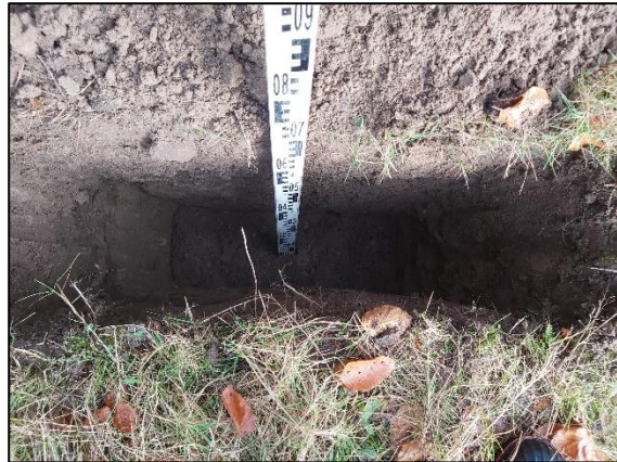
Figuur 6 Proefsleuf op 2 m uit de kroonprojectie van de Sijsseltselaan
