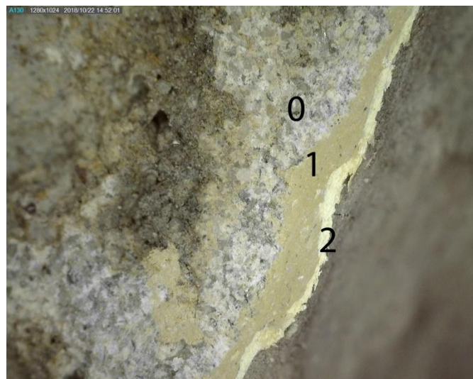
Microscoopopname kleurentrap C van een monster afkomstig van één van de kolommen. Door de lamp van de DinoLite kleurt het groen wat lichter en het wit wat geel.
