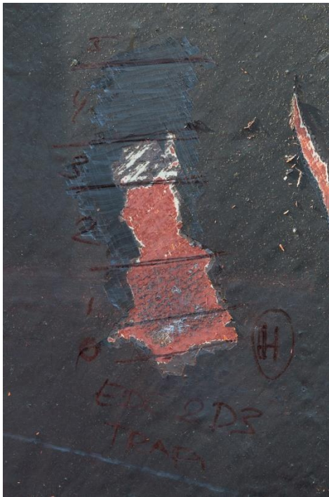
Kleurentrapje H met groene en rode afwerklagen en een witte grondverf daartussen.
