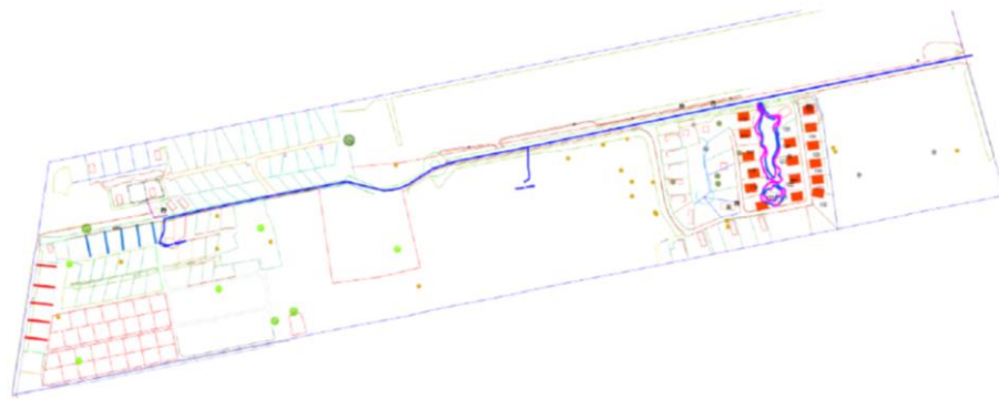
Figuur 5: Twee bestaande persputten plus persleiding richting Arnhemseweg (bron: Van Manen Infra Westbroek BV)
