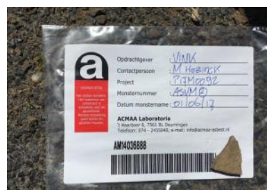
Foto 6: Asbestverdacht plaatmateriaal inspectiegat 3
