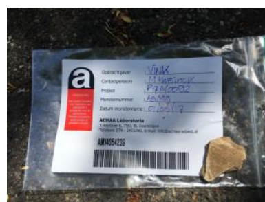
Foto 3: Asbestverdacht plaatmateriaal inspectiegat 2
