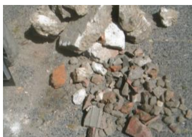
Foto 5: Uitkomend puinhoudend materiaal inspectiegat 3
