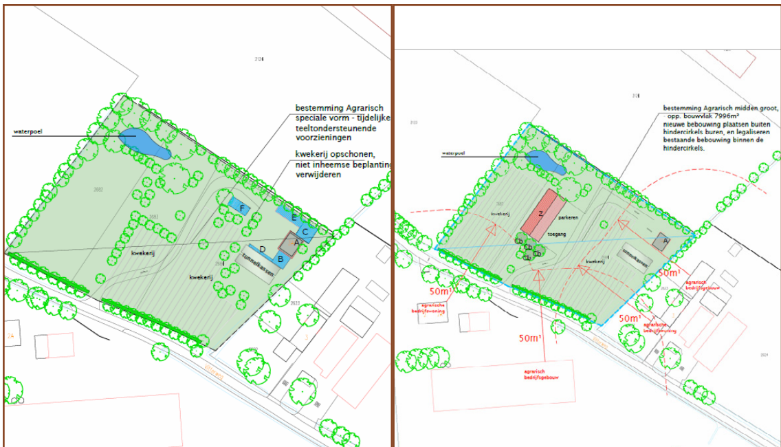
Afb. 1.2: Tekening bestaande situatie (links) en toekomstige situatie (rechts). Een deel van de bebouwing verdwijnt (blauw gekleurd). De kantine/berging blijft gehandhaafd (grijs gekleurd). De erfkavel wordt heringericht en er vindt nieuwbouw plaats (rood gekleurd). Bron: Architectenbureau DBL Lunteren.
