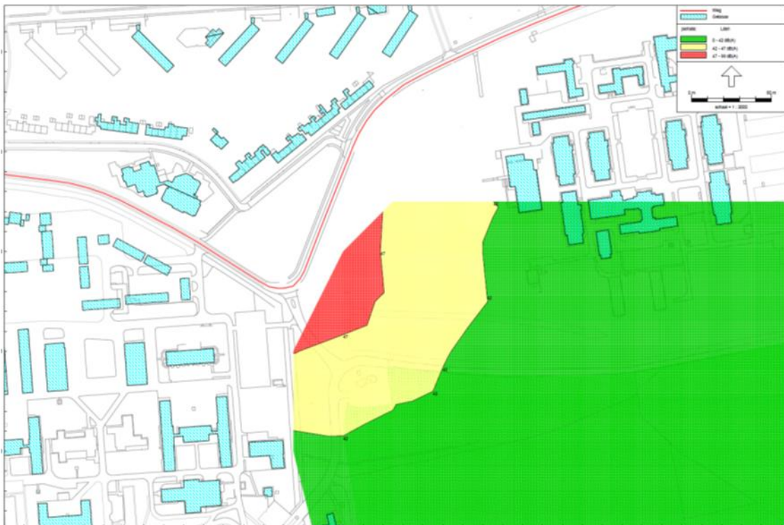
Figuur 6. Detailkaart geluidcontouren 42 en 47 dB(A) in de Sysselt met alleen aanleg zuidelijke Parklaan, variant 2.
